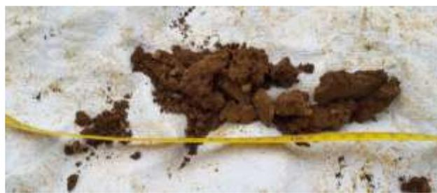
Le potentiel de réserve hydrique des sols est aussi influencé par la composition de la terre fine ainsi lors des sondages à la tarière, il a été réalisé un test du boudin sur plusieurs échantillons de terre.
